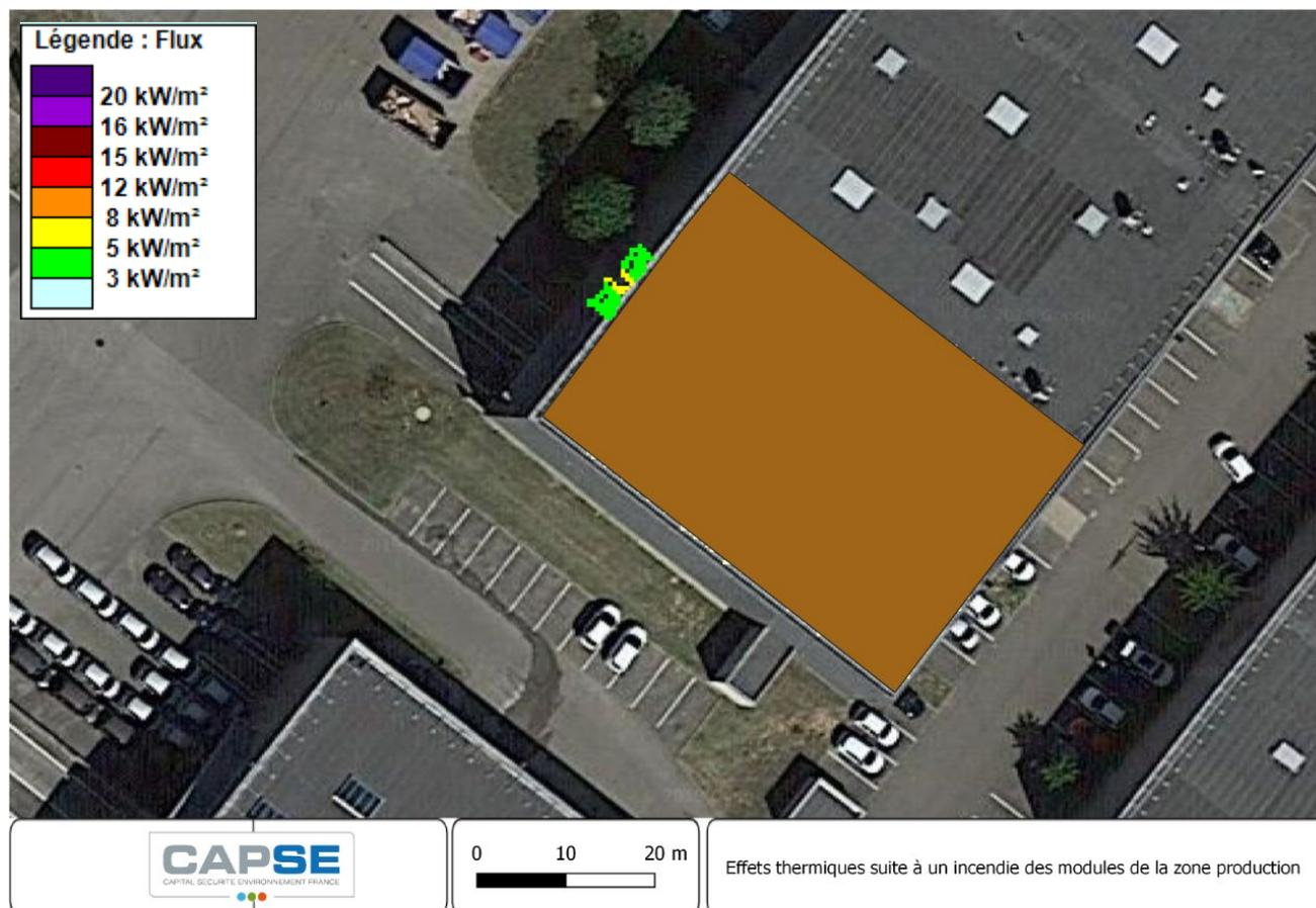
Figure 7 : Effets thermiques suite à un incendie des modules de la zone de production (logiciel Flumilog)
